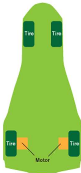
インホイールモーター方式 (ニッサン ブレイドグライダーの例)
