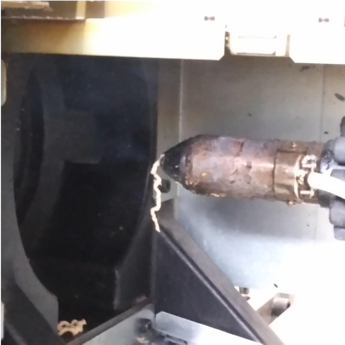
図 1.1.2.1.5 樹脂漏れ状況 (成形温度 240℃)
