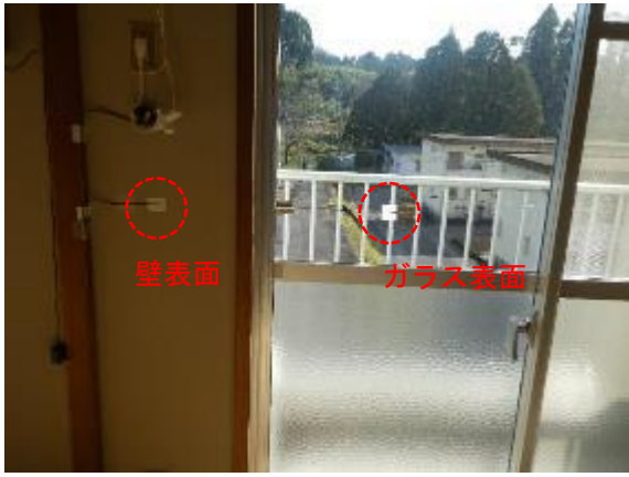
図Ⅱ-4-2-13 壁・ガラス表面温度測定（和室1）
