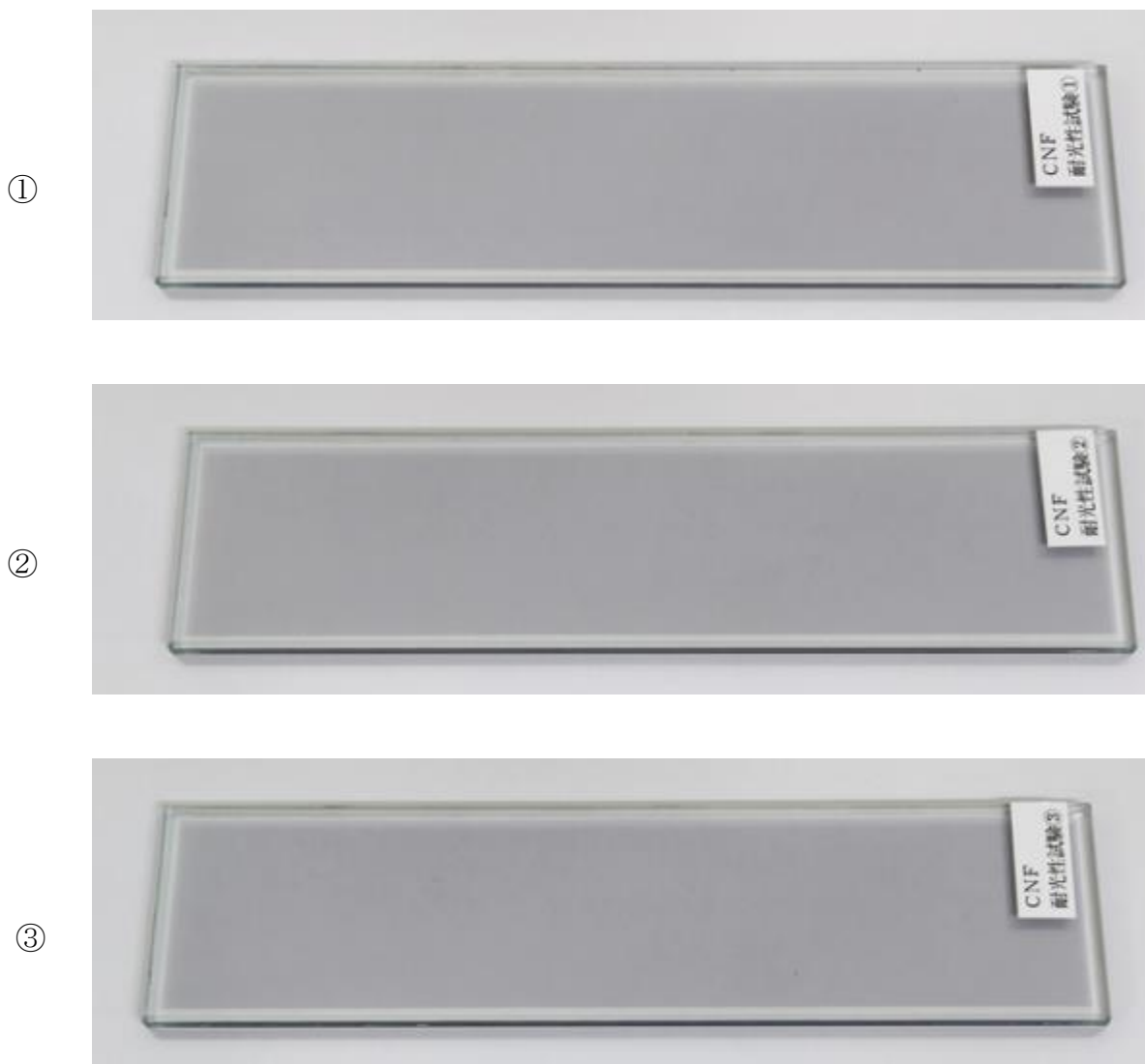
図 II-2-2-3 耐光性試験前の試作体
