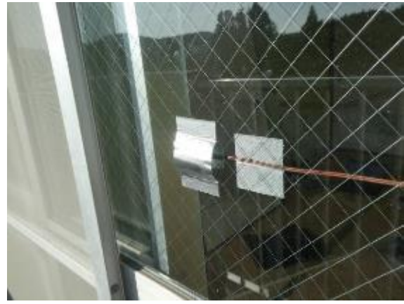
図Ⅱ-4-2-13 壁・ガラス表面温度測定（和室1）
