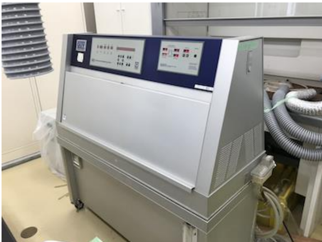
図Ⅱ-3-2-2 UVA-340 ランプを用いた耐光性試験機(熊本県産業技術センター保有)
