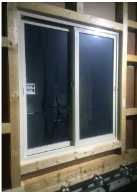
図Ⅱ-1-2-20 耐風圧性評価試験
