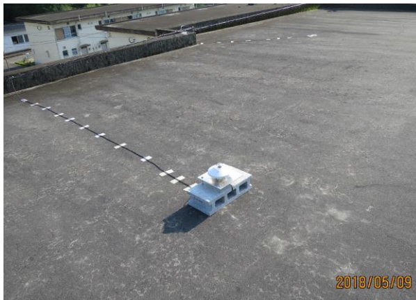
図Ⅱ-4-2-15 左：屋上に設置した日射計、右、屋根表面温度測定（2号棟）
