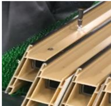
図 II-1-2-12 切断後加工途中の CNF 樹脂サッシ部材
