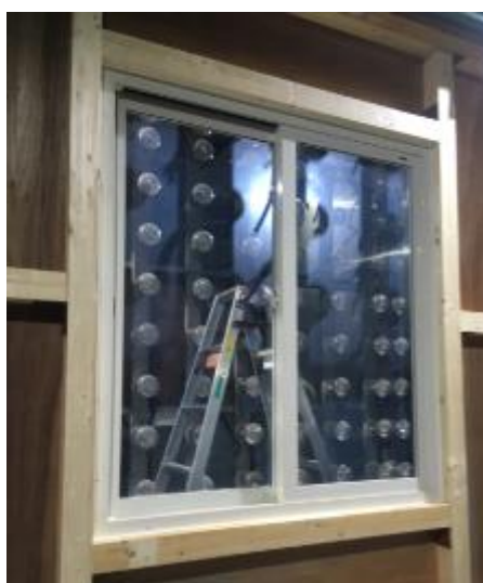
図Ⅱ-1-2-22 耐熱耐寒性評価試験
