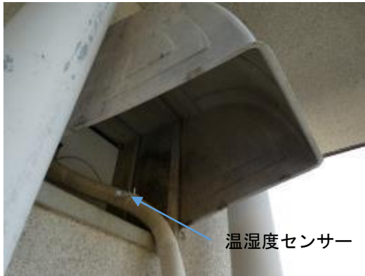
図Ⅱ-4-2-10 計測器設置の様子（外気温湿度）
