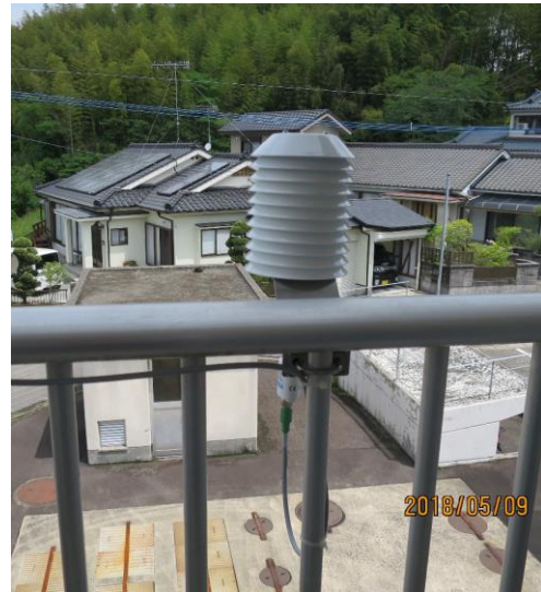
図Ⅱ-4-2-10 計測器設置の様子（外気温湿度）
