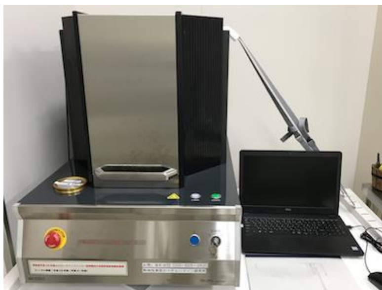
図Ⅱ-3-2-3 熱拡散率測定装置(熊本県産業技術センター保有)
