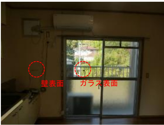
図Ⅱ-4-2-14 壁・ガラス表面温度測定（DK）
