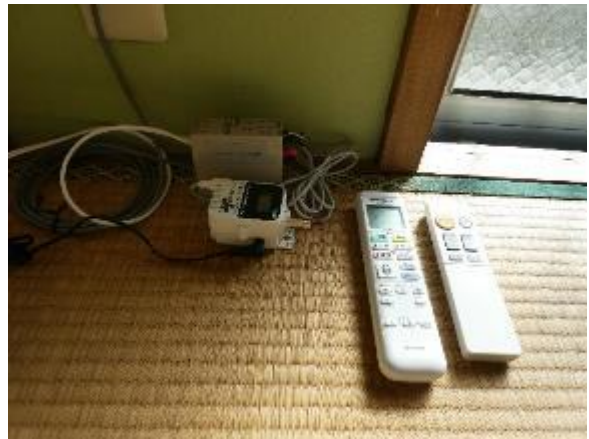
図Ⅱ-4-2-11 エアコン消費電力量計測器設置の様子 （左：エアコンとCT、右：電力量計とパルス測定器）
