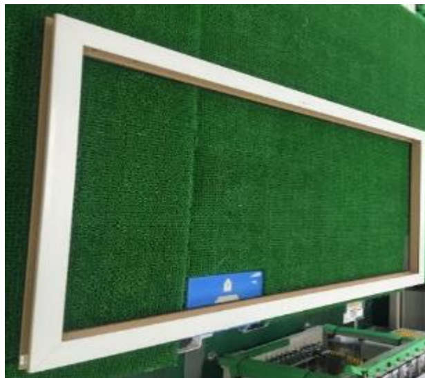
図 II-1-2-13 組立(溶着)後の CNF 樹脂サッシ部材
