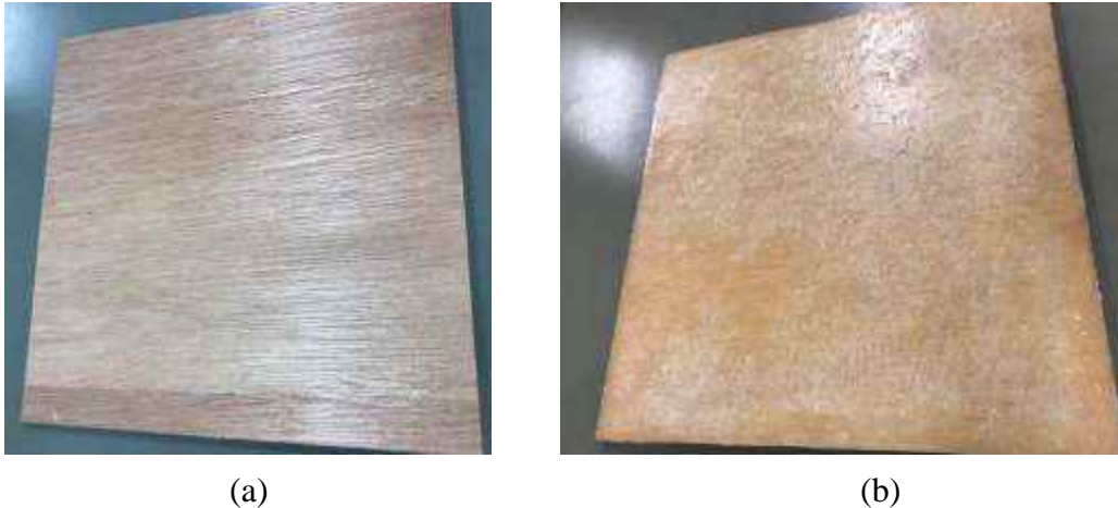
図 57 試作した高剛性化粧合板 (a) 使用した合板 (b) 高剛性化粧合板
