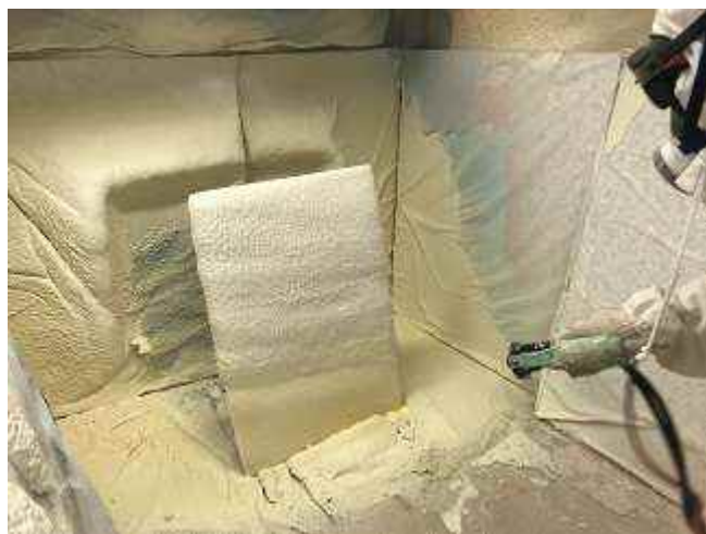
図 192 ウレタン吹付工程写真 (CNF 添加有)
