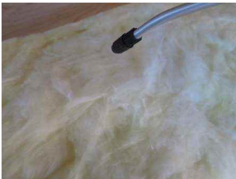
図 67 CNF が散布されたグラスウール断熱材
