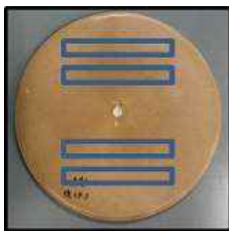
図 77 曲げ試験片の切り出し位置
