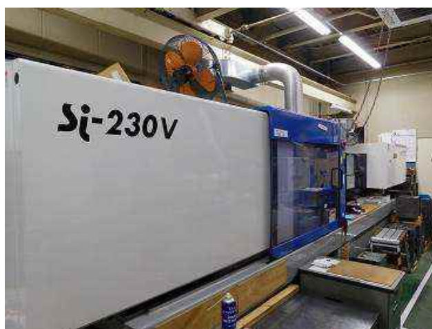
図 112 量産試作に用いた射出成形機 (Si-230V-H370C、東洋機械金属製)
