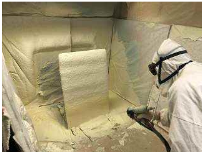
図 191 ウレタン吹付工程写真 (CNF 添加無)
