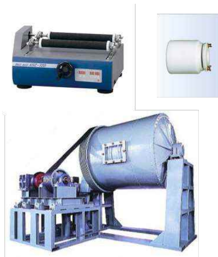
図 23 卓上ミル架台とポット、工業用大型ミル
