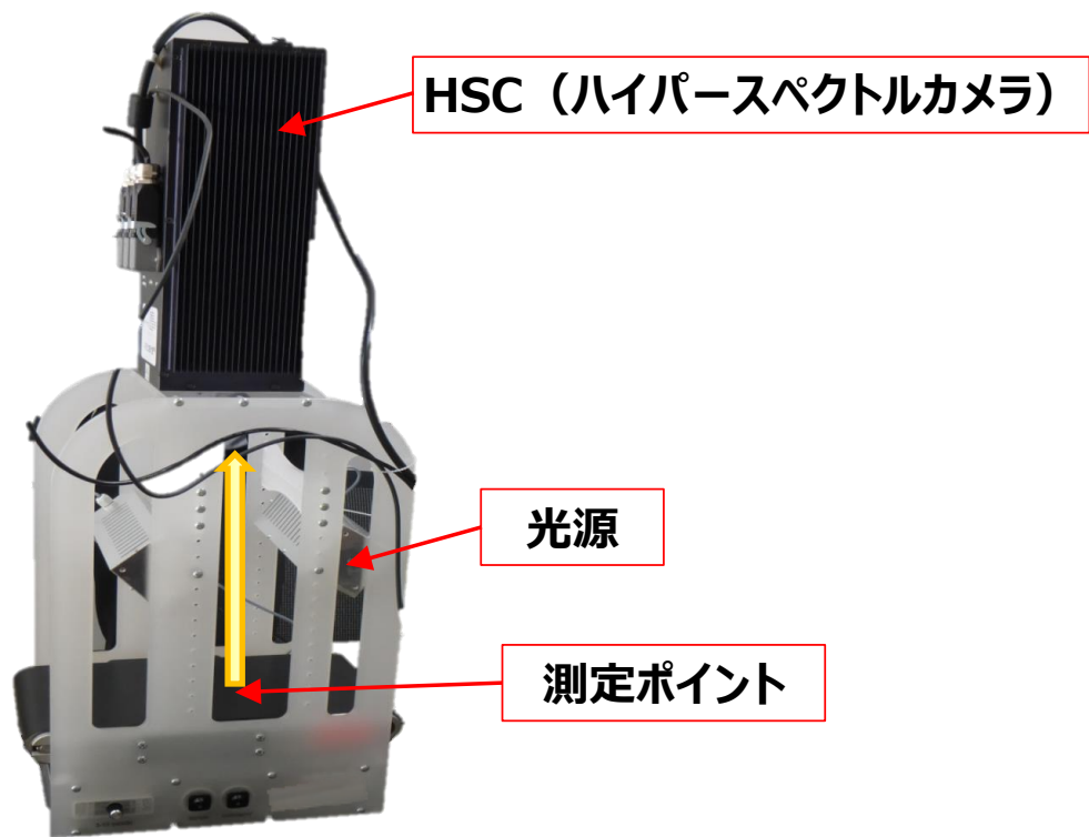
図 2-1-3 (19) ハイパースペクトルカメラ (HSC) による測定の様子
