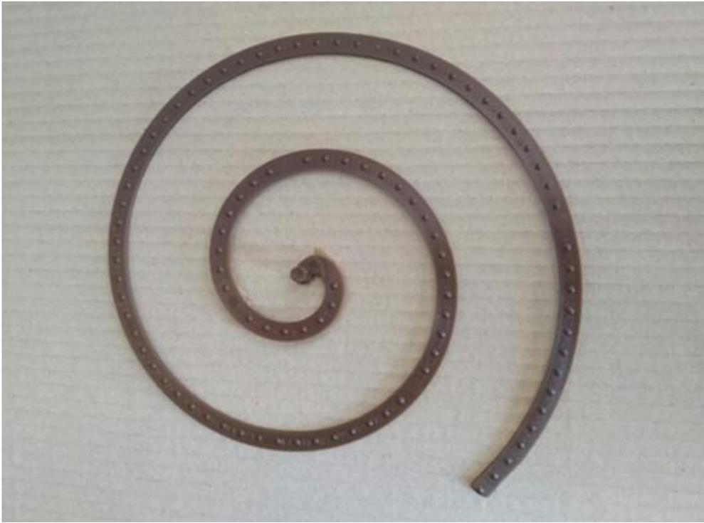
図 3.1.3.1 スパイラルフロー試験成形体の写真
