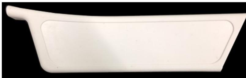
図(2)-29 PP-CNF15%材における車載部品スカッフプレート白着色成形品外観
