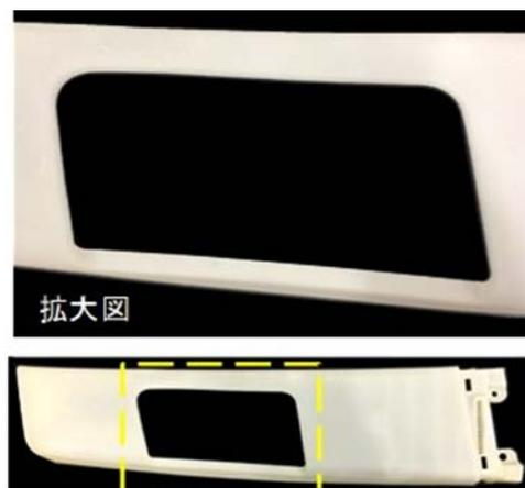
図(2)-32 振動試験後Bピラー外観
