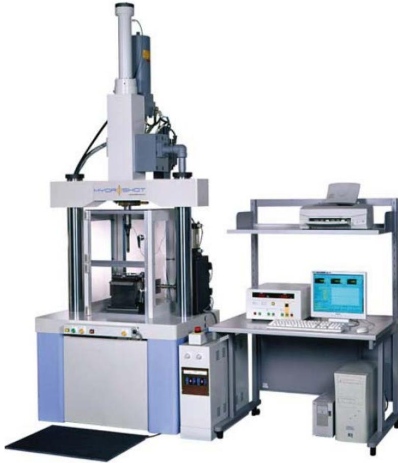
図(1)-2 高速衝撃試験機 HITS-P10
