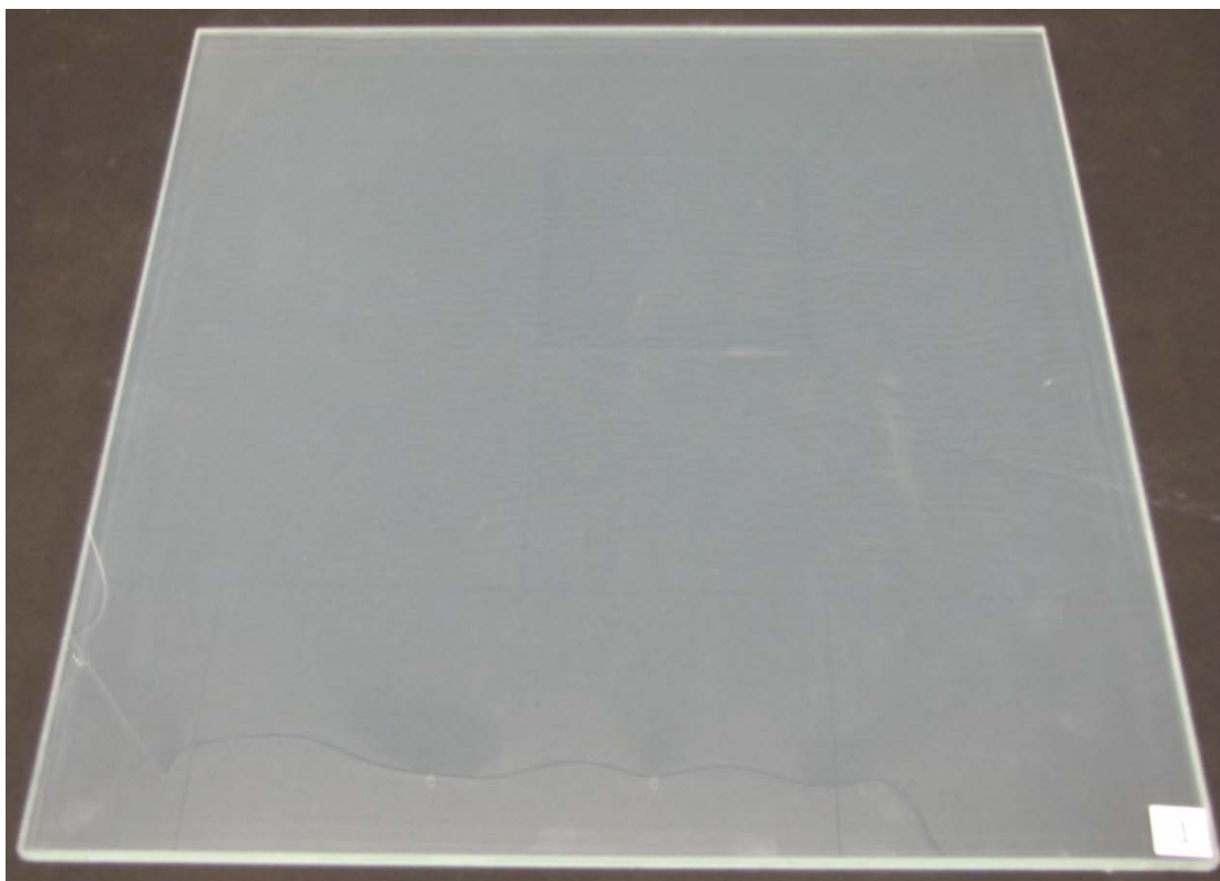
図Ⅱ-2-2-8 耐湿性試験前の試験体①の外観写真
