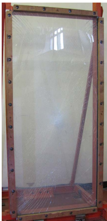
図Ⅱ-2-2-19 ショットバック試験後の試験体①の外観写真
