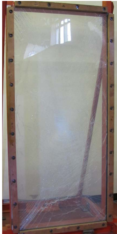
図表Ⅱ-2-2-22 ショットバック試験後の試験体④の外観写真
