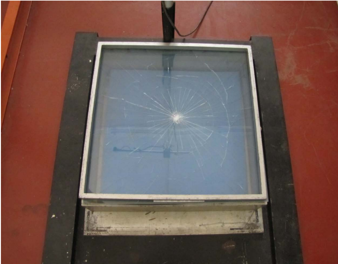
図 II -2-2-17 落球試験後の試験体④の外観写真
