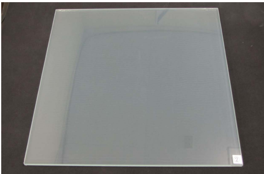
図Ⅱ-2-2-12 耐湿性試験後の試験体②の外観写真
