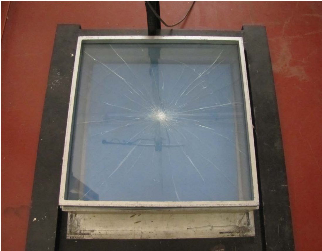
図Ⅱ-2-2-15 落球試験後の試験体②の外観写真
