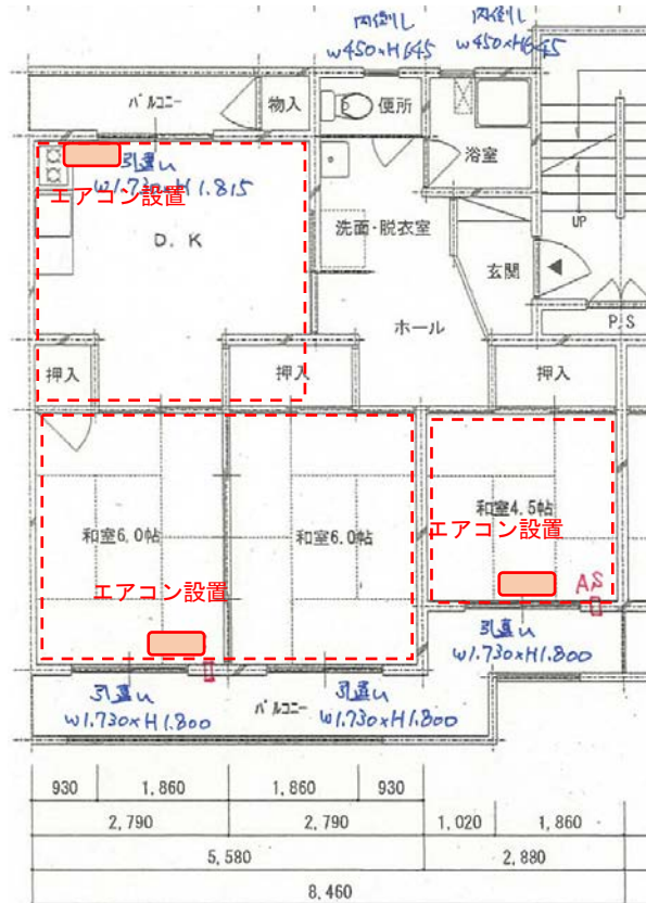
図 II-4-2-13 エアコン設置位置、冷暖房範囲
