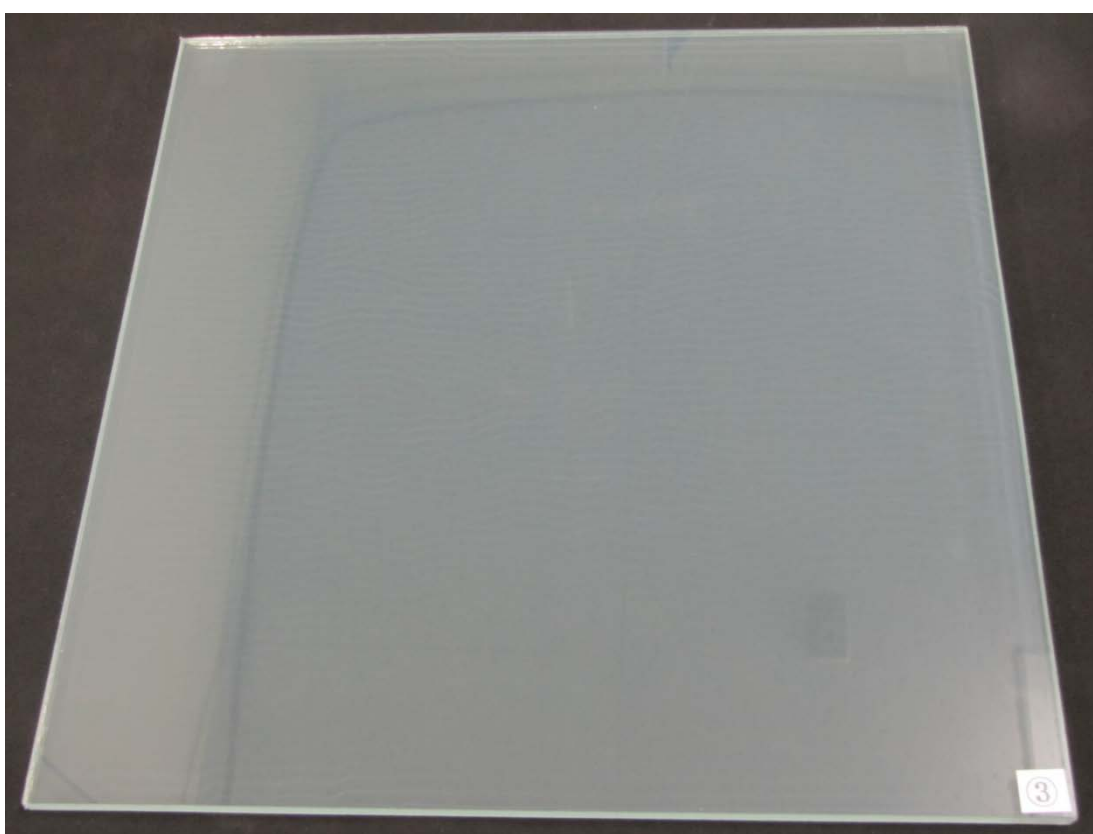
図Ⅱ-2-2-13 耐湿性試験後の試験体③の外観写真
