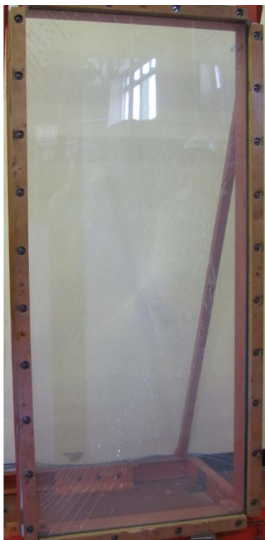
図Ⅱ-2-2-20 ショットバック試験後の試験体②の外観写真
