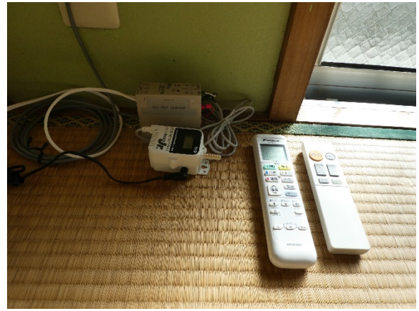
図Ⅱ-4-2-11 2号棟 231 室のエアコン消費電力量計測器設置の様子 (左：エアコンと CT、右：電力量計とパルス測定器)
