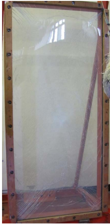
図Ⅱ-2-2-21 ショットバック後の試験体③の外観写真
