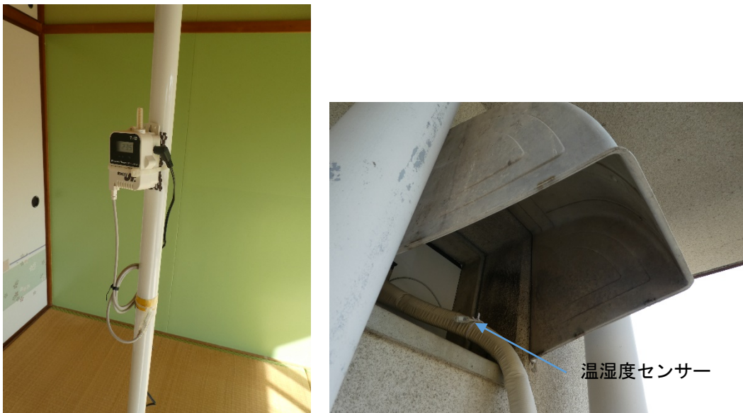
図Ⅱ-4-2-10 2号棟 231 室の計測器設置の様子（左：室内温湿度、右：外気温湿度）
