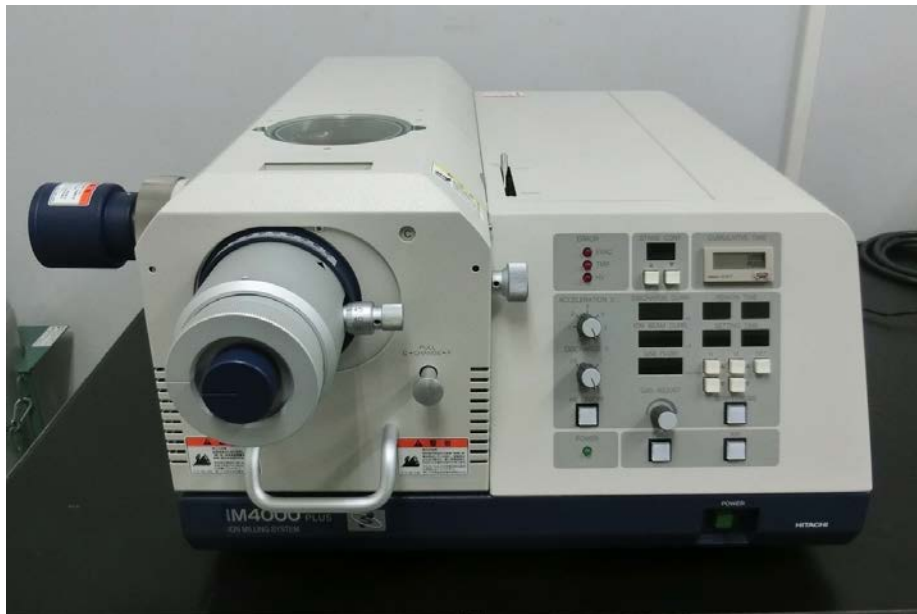
図Ⅱ-5-2-8 (株)日立ハイテクノロジーズ製のイオンミリング装置 (IM4000)
