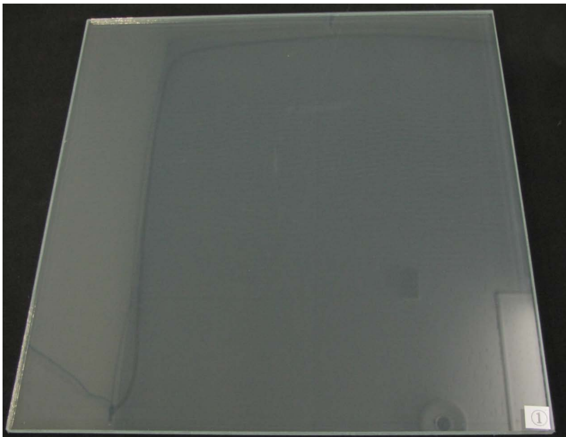
図Ⅱ-2-2-11 耐湿性試験後の試験体①の外観写真
