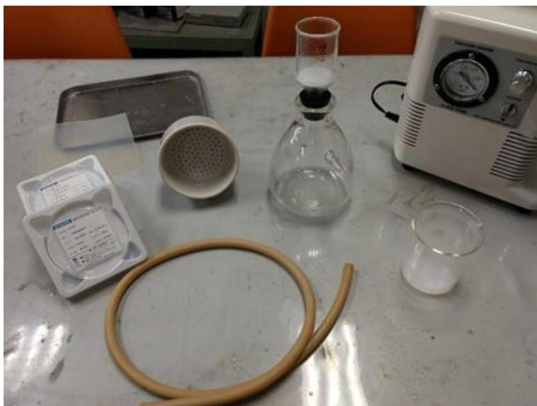
図 2-140 吸引ろ過に使用した装置
