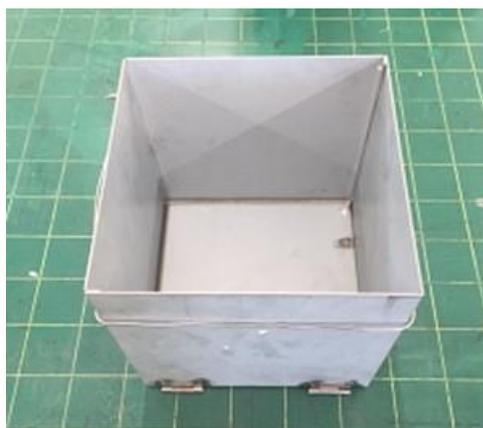
図2-72 使用した流し込み型
