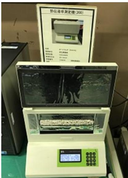
図 2-128 熱伝導率測定装置
