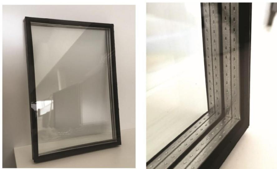
図 2-117 多層ガラス試作体 (左) およびコーナー部 (右)
