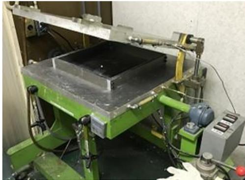
図2-135 成形用型締め機
