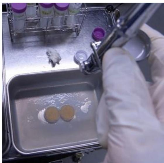
図2-49 CNF 散布の様子
