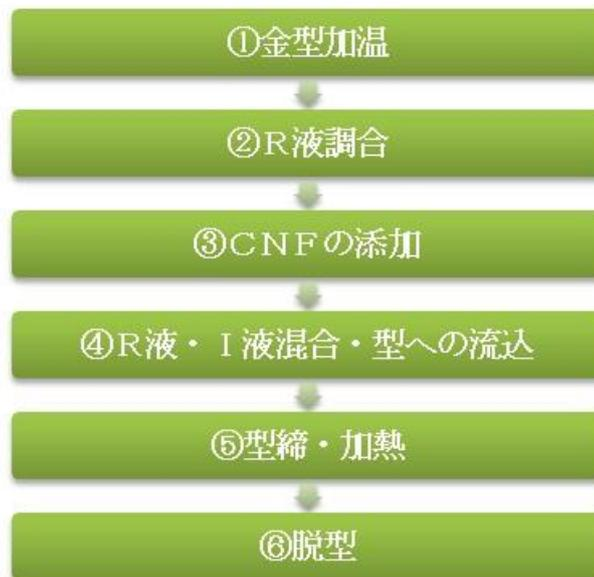
図2-136 ウレタンボード試作品の作製方法
