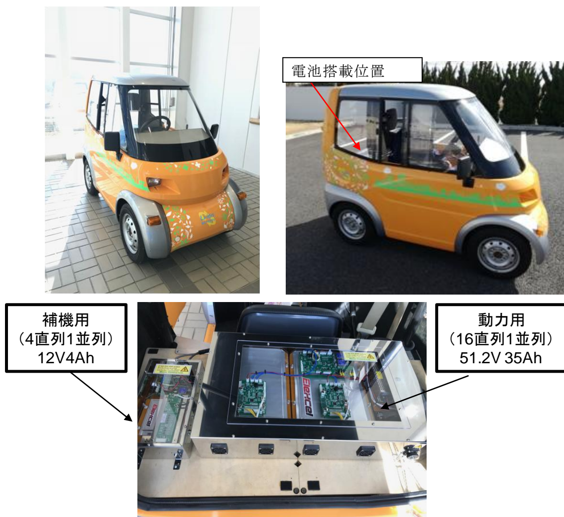
図 4-29. マイクロ EV 外観（上） / 搭載電池モジュール外観（下）
