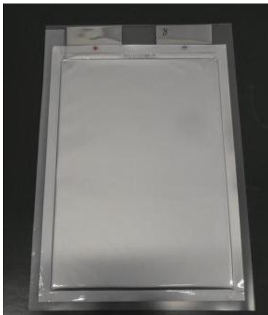
図 4-26. 試作セル外観写真 (35Ah クラス正極 CNF+CMC 系/負極黒鉛単独系)
