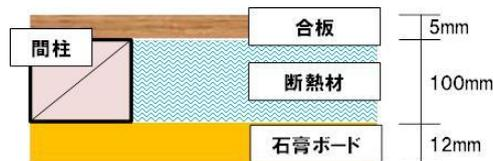
図-2. 5 既存外壁部品の構成
