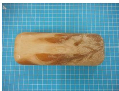
図－２． 1 7 CNF 添加発泡成形試作品
