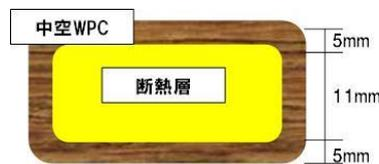
図－２．９ 中空部に発泡層を設けたウッドプラスチックフロア
