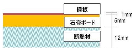
図-2.32 既存浴室壁（汎用タイプ）部品の構成
