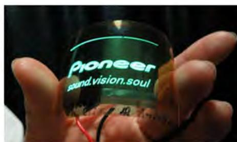
CNF透明基板上で発光させた有機EL素子
