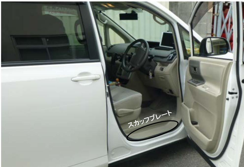
図(2)-16 スカッフプレート取付け位置
