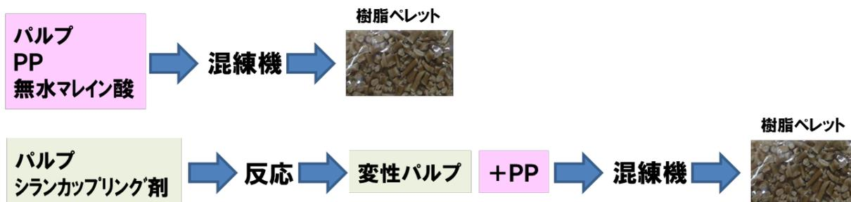
図(1)-6 無水マレイン酸とシランカップリング剤の変性プロセス
