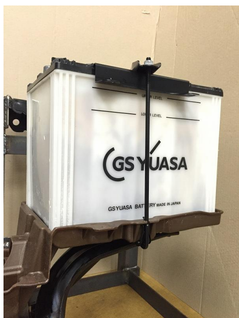
図 3.1 バッテリー取付け状態
