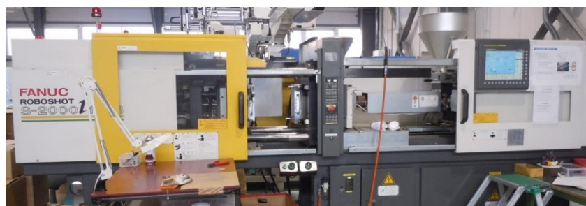
図 1.3.2.3.2 射出成形機 FANUC S-2000i 100B
