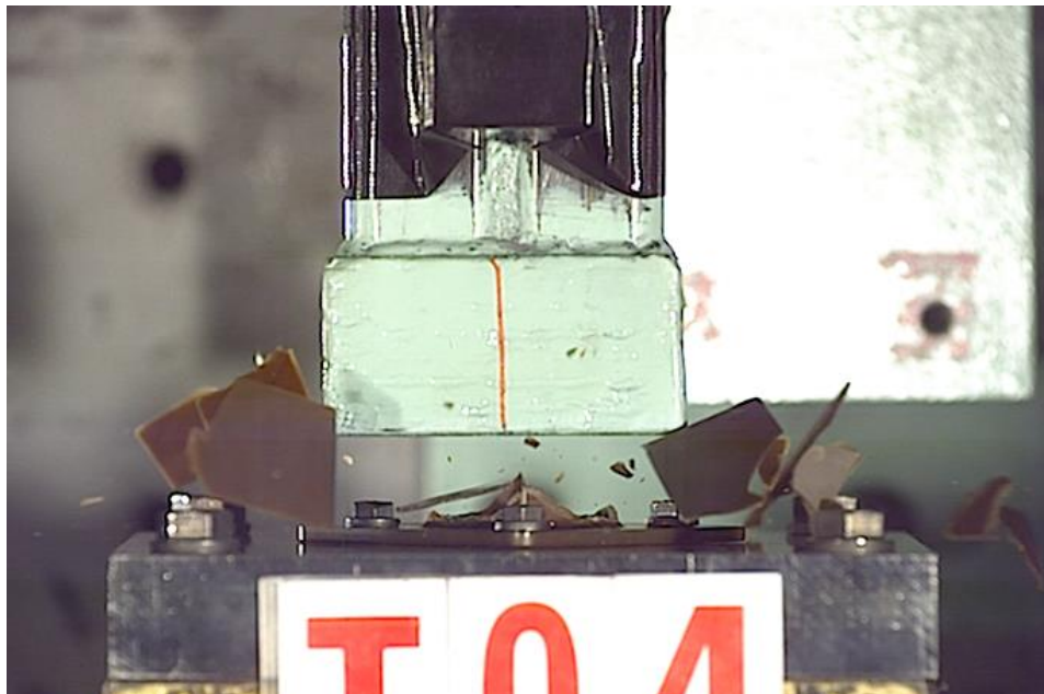
図 1.3.2.2.4 PP-CNF20 の破壊瞬間状態
