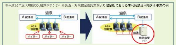
温泉街の未利用熱活用として各施設毎のボイラーによる加温から、熱回収型ヒートポンプを活用した集中 給湯に変更した場合、地域全体CO<sub>2</sub>排出量の4%削減できる。(その他全ての対策を行うと21%削減)
