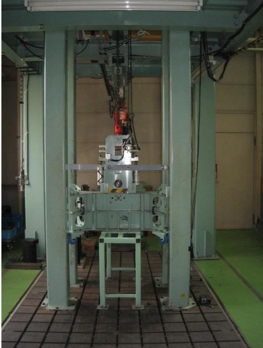
圖 1. 3. 1. 2. 2 落錘衝擊試驗機
