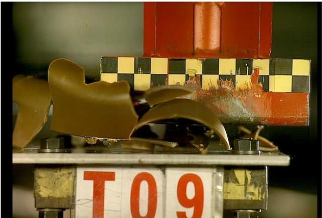
図1. 3. 1. 2. 6 落錘衝撃試験時の試験体破壊状況
