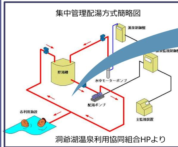
温泉供給設備（配管、ポンプ、タンク、制御装置等）を省エネ効果が高い設備に更新することにより温泉街全体での低炭素化を図る。
