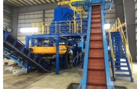
導入設備 (特殊高度破碎機)
