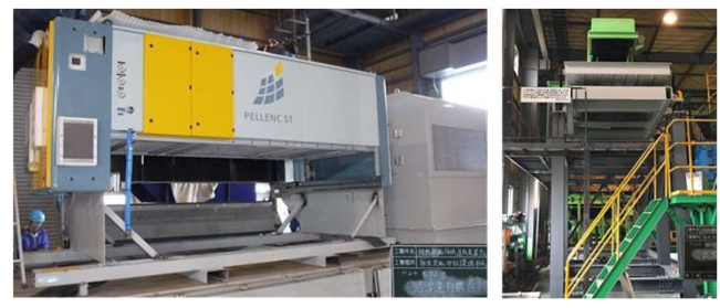
導入選別機の外観と設置状況 (画像提供 : 株式会社中村環境)
