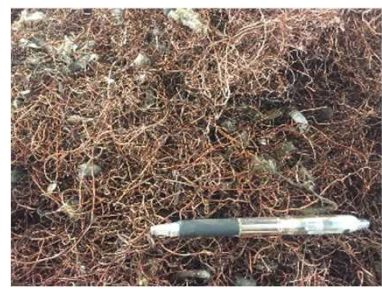
破碎後の回収素材 (銅濃縮物)
