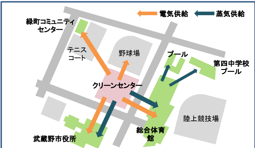
公共施設のエネルギー供給拠点
