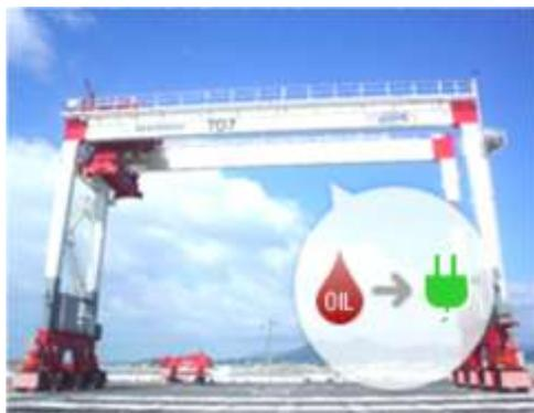
海上のコンテナを積み降ろしするためのコンテナ荷役用クレーン。ディーゼル式から電動化方式へ。
