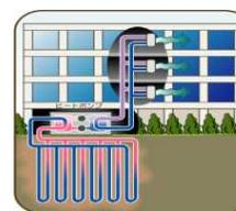
地中熱・下水熱等の温度差エネルギーをオフィス等の空調に活用することによりCO2排出削減を実現。また、ヒートアイランド現象の抑制にも貢献。
