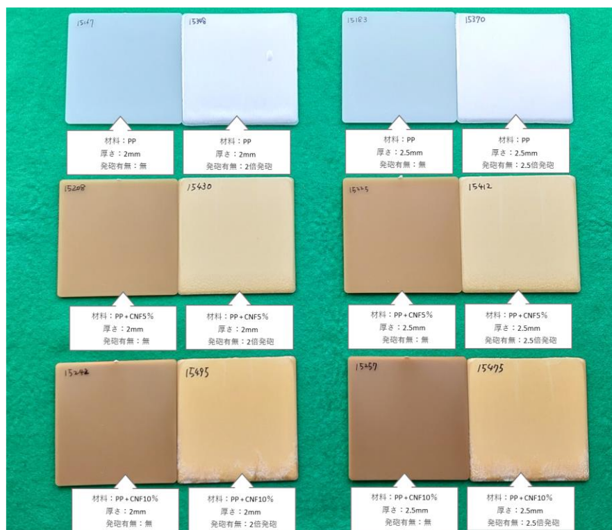
図 2 薄板射出成形品の外観（厚さ：2 / 2.5mm、発泡：無/有）
