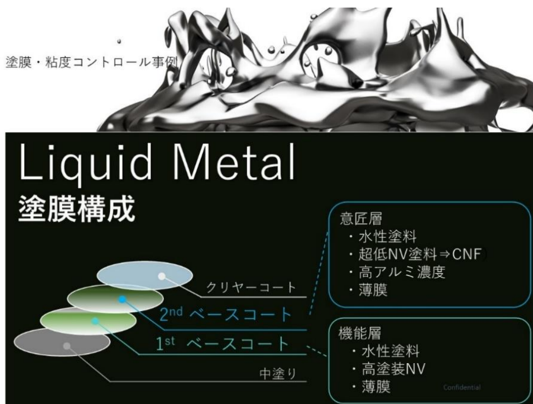
図 4.3.3 塗膜（リキッドメタル）の構成
