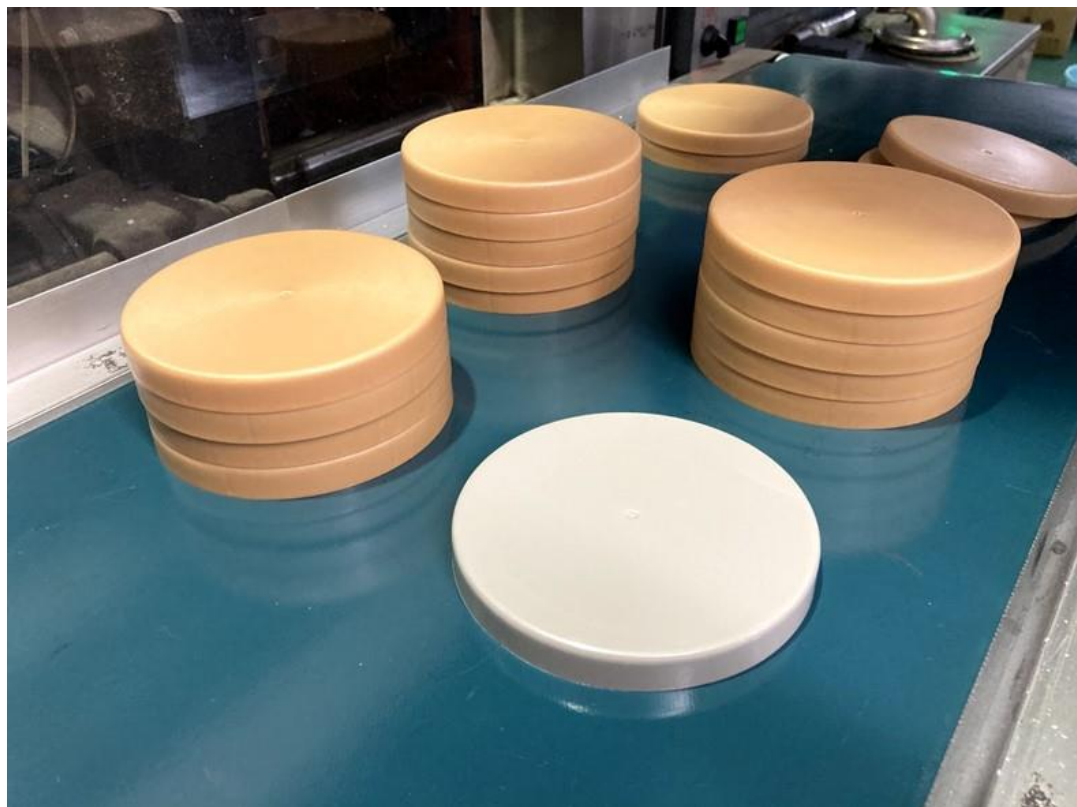
図1 ロケーティングキャップの外観（黄褐色：CNF10%PP、白色：PP）
