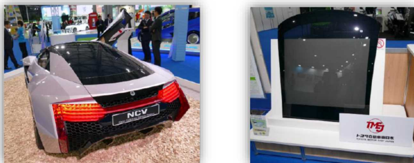
図 コンセプトカーに採用されたルーフパネルとバックドアガラス（左）と透明樹脂材料の補強技術を使用したルーフパネル（右）
