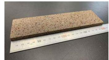
図 CNF 添加高断熱無機ボードの外観図
