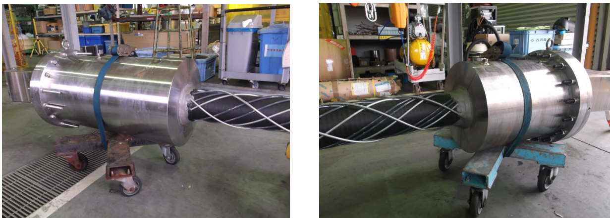
図 2-71 組み立て後の端末モデル（左：従来構造、右：軽量化構造）
