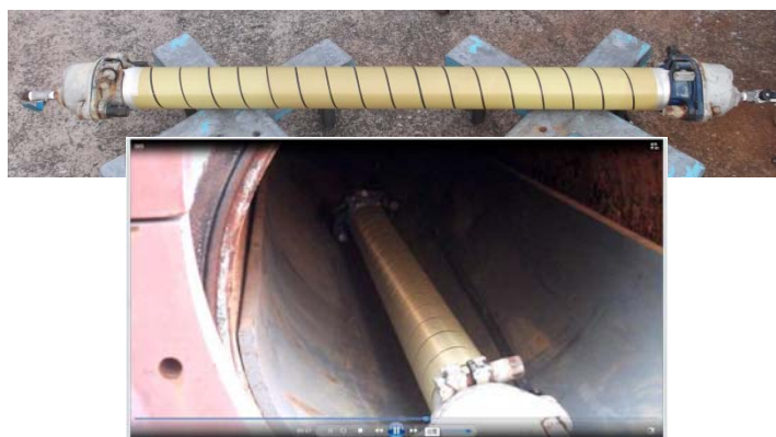
図 2-53 試料外観及び防護容器内設置状況
