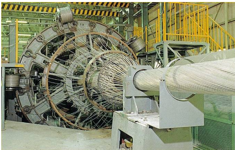
図 2-60 軸力補強層の巻き付け状況
