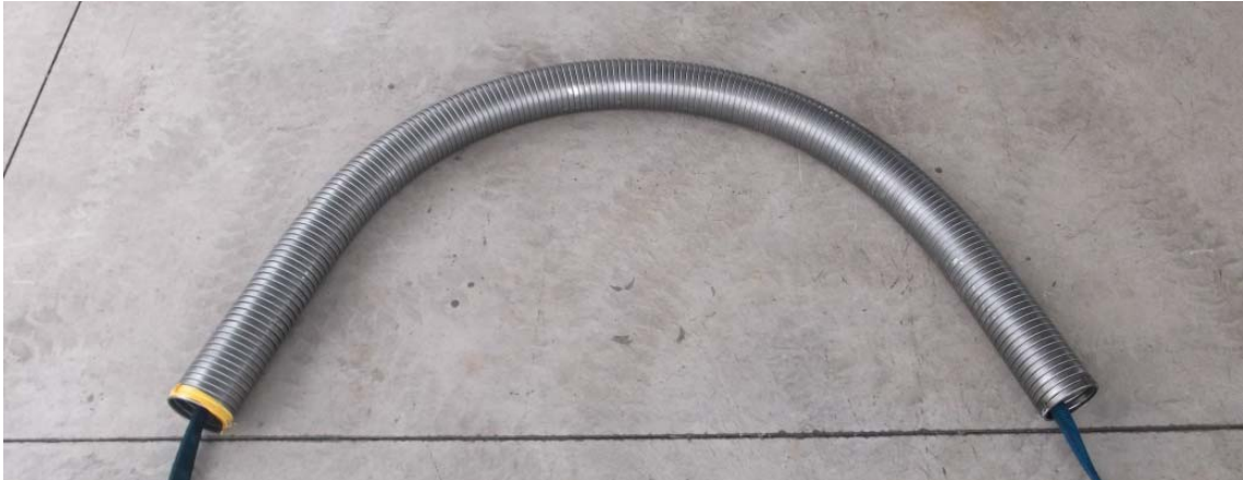
図 2-50 インターロック管の曲げ試験
