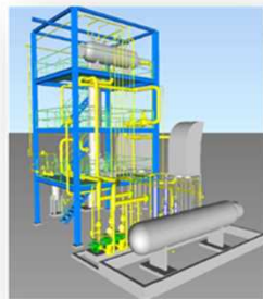
本実証事業における メタネーション設備の建設
