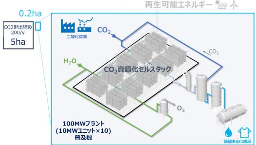
1kWシステムの基本設計をベースにした100 kW~MW普及機での早期社会実装を目指す
