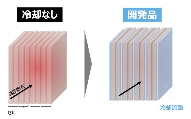
セル間に冷却流路を設けることで**効率的な冷却を実現** 発熱量に応じた冷却流路の設計でスケーラブルなスタック化が可能
