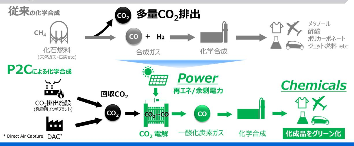
回収CO<sub>2</sub>と再エネ/余剰電力(Power)から CO等の化学原料(Chemicals)を製造し化成品をグリーン化
