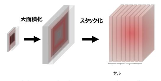
大面積化・スタック化に伴い、セルからの放熱量が低下し、 セル温度が上昇
