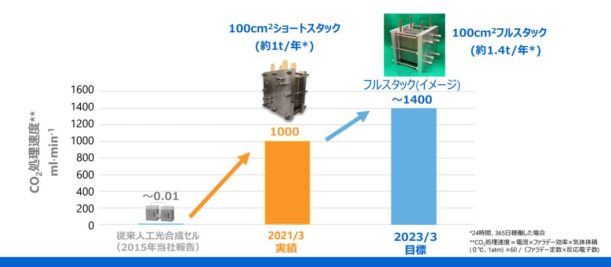
独自のCO2電解スタックの開発により、最大年間1.0t\*のCO2処理を達成
