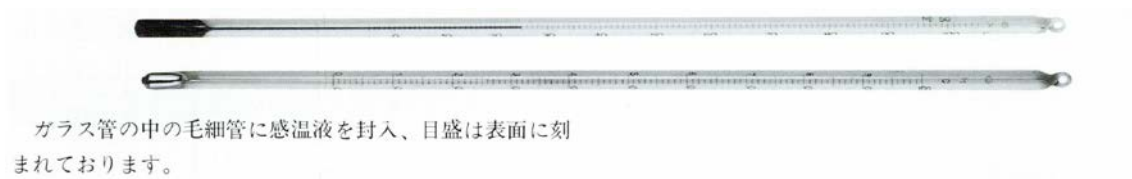
(写真)ガラス製水銀温度計の例
