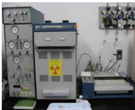
電子捕獲検出-ガスクロマトグラフィー装置
