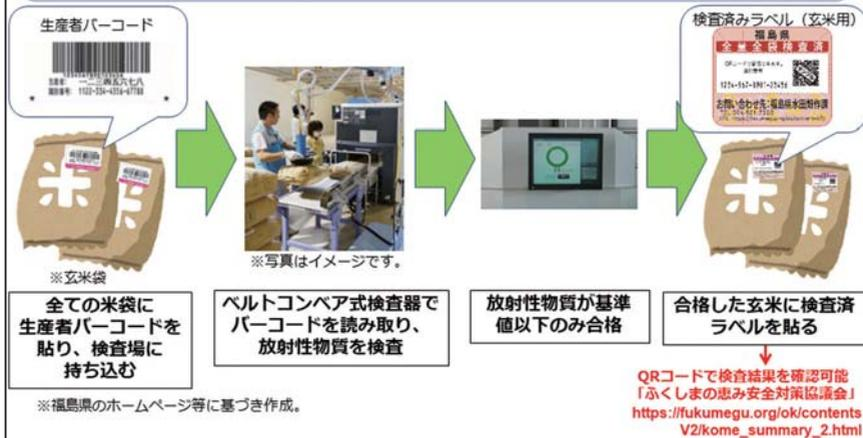
福島県では、2012年産米から、ベルトコンベア式の検査器を用い、国から指示された地域のみならず県内全域での全袋検査を、県の取組として実施しています。
