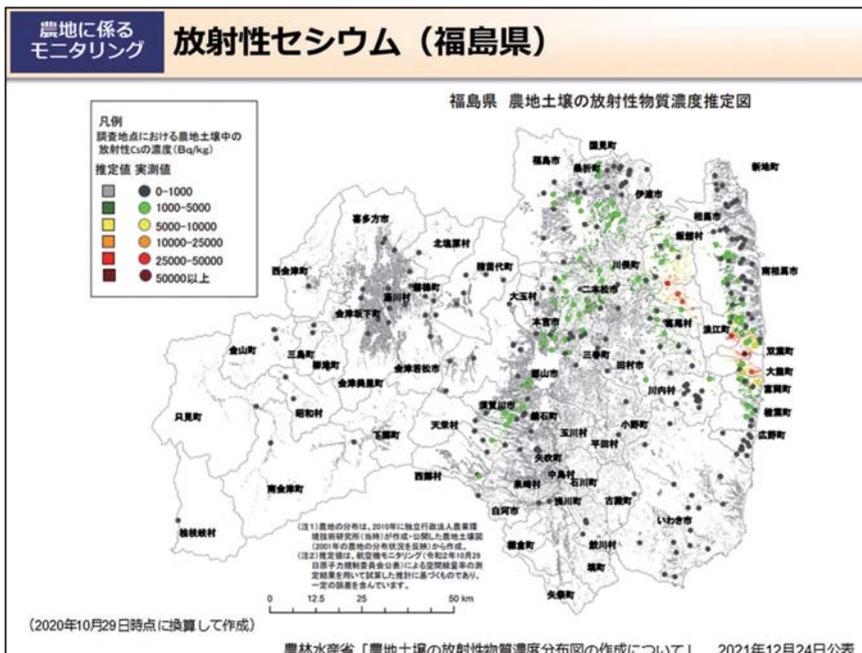
東京電力福島第一原子力発電所事故により、放射性物質の影響を受けた福島県内の農地において、今後の営農に向けた取組を進めるために、農地土壌の放射性物質の測定調査が行われています。上図は、福島県の329地点において2020年度に行われた測定結果等に基づく、農地土壌の放射性セシウム濃度の推定図（2020年10月29日時点に換算）です。
