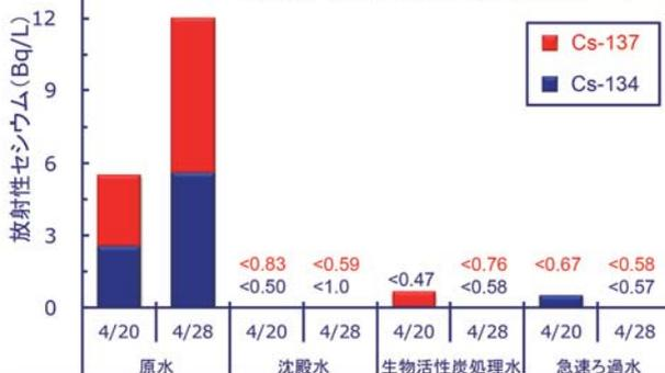
業務用等の放射性物質の除去技術として、ゼオライトやイオン交換、ナノ過膜、逆浸透膜があるが、いずれも費用や設備、効率の観点（特に、ナノ過及び逆浸透膜の場合は電力が多く消費される）から、通常の浄水処理には適用しにくい。
