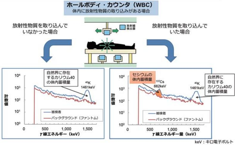
ホールボディ・カウンタは、体の中から出てくる $\gamma$  (ガンマ) 線を計測する装置です。放射性核種によって、 $\gamma$  (ガンマ) 線のエネルギーが異なるため、特定のエネルギー、例えば、放射性カリウム (カリウム40) の $\gamma$  (ガンマ) 線エネルギーである1,461キロ電子ボルト (keV) に着目すると、体内の放射性カリウムからの $\gamma$  (ガンマ) 線であることが分かります。なお、セシウム137の $\gamma$  (ガンマ) 線エネルギーは662キロ電子ボルト (keV) です。
