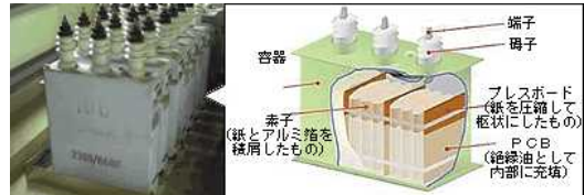
コンデンサ(蓄電器):電気を一時的に蓄える、電圧を調整するなどの役割を持つ装置
