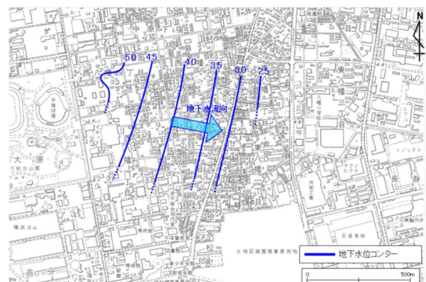
図 2-2 地下水の流れと地下水位等高線 春季：平成 29 年 5 月測定 (地下水位等高線の単位：標高 m)
