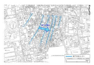
図2-3 地下水の流れと地下水位等高線 夏季:令和3年8月測定 (地下水位等高線の単位:標高m)
