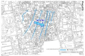
図2-4 地下水の流れと地下水位等高線 秋季:令和3年11月測定 (地下水位等高線の単位:標高m)
