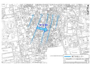
図2-2 地下水の流れと地下水位等高線 春季:令和3年5月測定 (地下水位等高線の単位:標高m)
