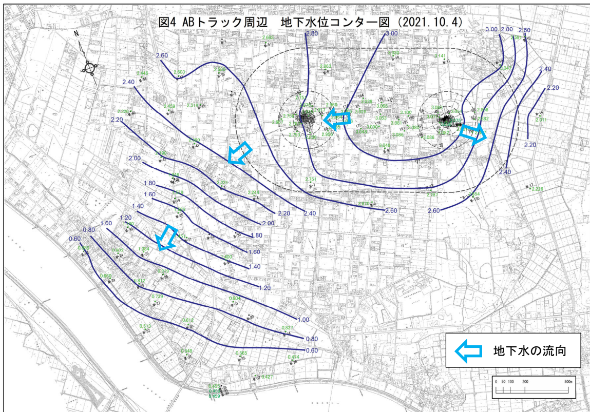
図5 ABトラック周辺の地下水位コンター図 (2021年10月4日) ※高水位時の流れの方向
