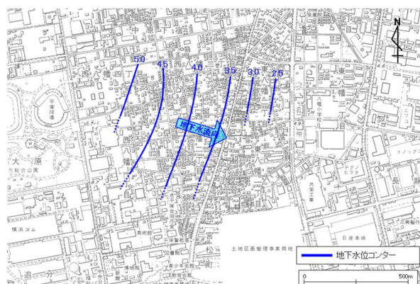
図 2-2 地下水の流れと地下水位等高線 春季：平成 28 年 5 月測定 (地下水位等高線の単位：標高 m)
