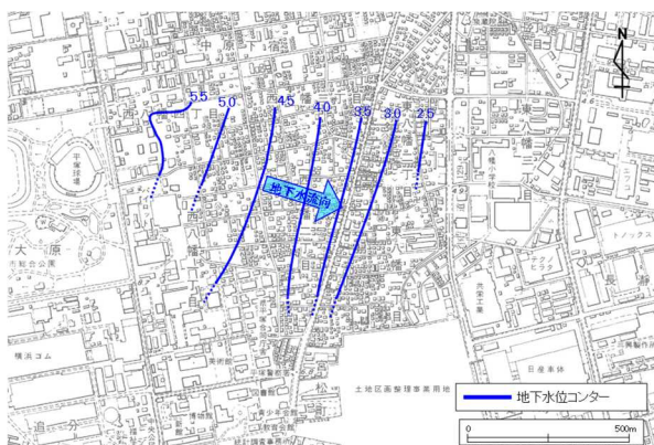
図 2-3 地下水の流れと地下水位等高線 夏季：平成 28 年 8 月測定 (地下水位等高線の単位：標高 m)
