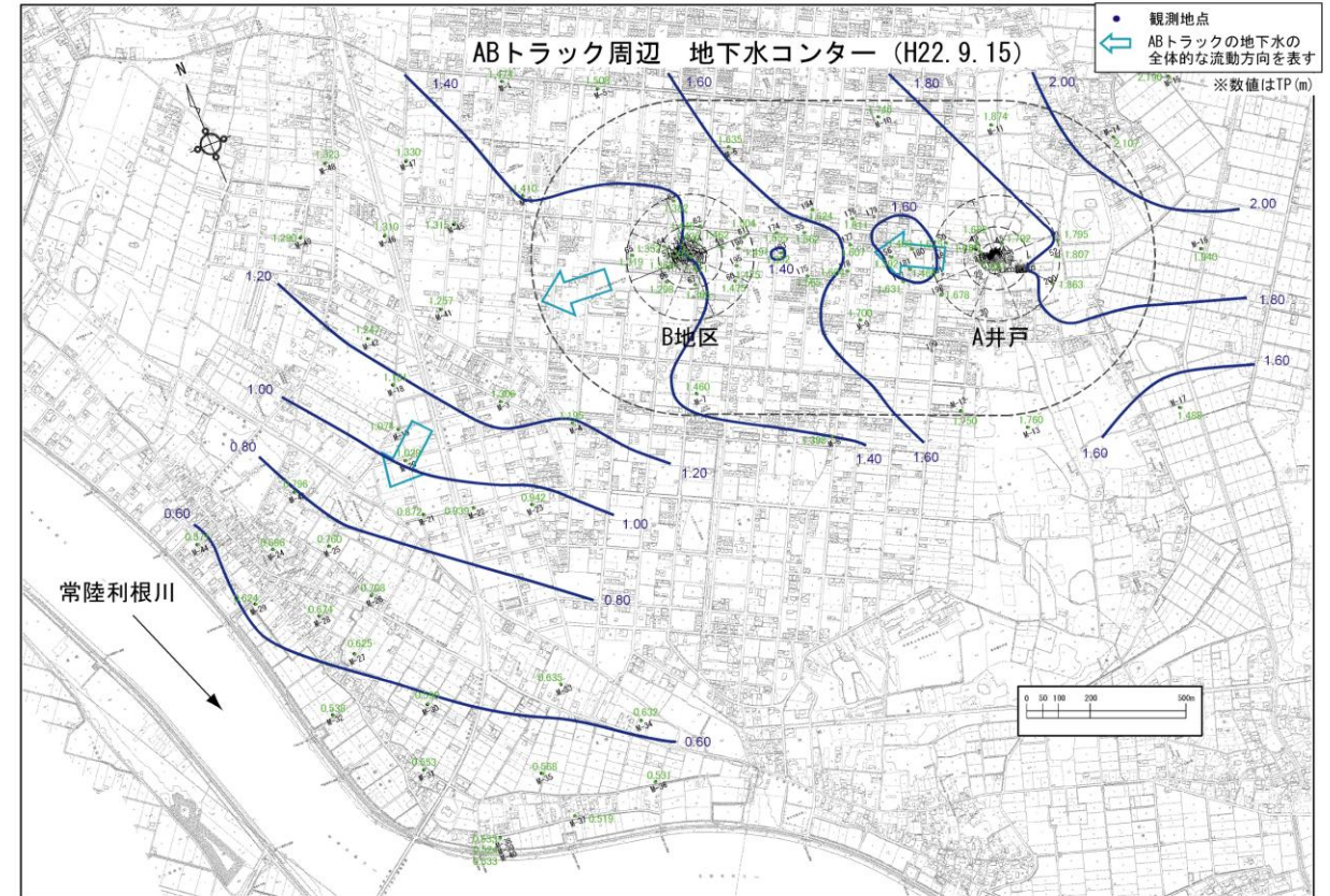
図3-1 地下水コンター
