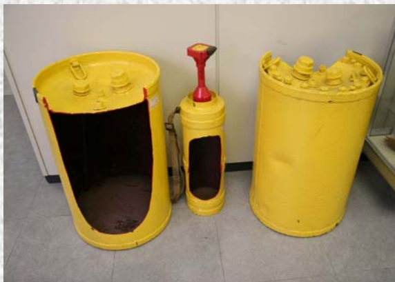
毒ガス貯蔵容器(左・右)と毒ガス撒布用補給缶 (これらの容器の黄色い塗装は発見後付されたもので、現物には塗られていません。左右の容器は高さ約74cm・直径約48cm、中央の補給缶は高さ約60cm・直径約20cm。中身は空です)
