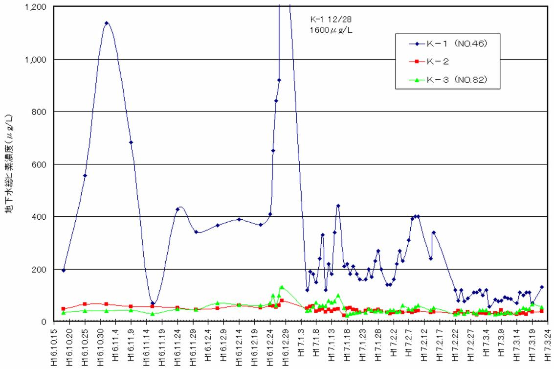
図8 掘削現場北縁での地下水モニタリング結果
