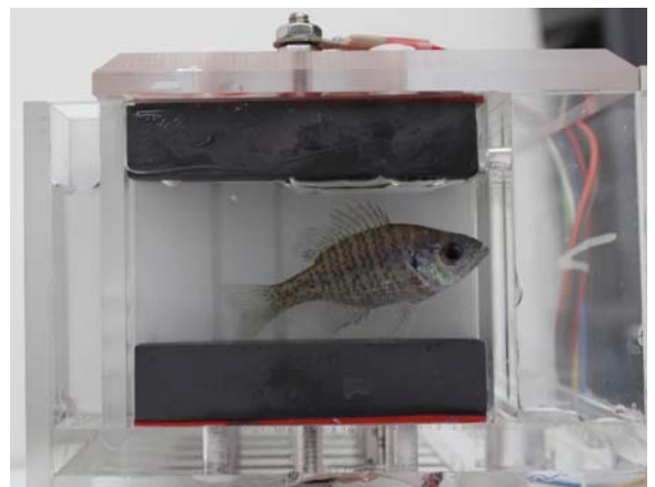
インテリジェント水生 バイオモニタリングシステム (iABS)
