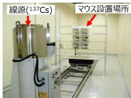
図 II-2  $\gamma$  線連続照射装置
