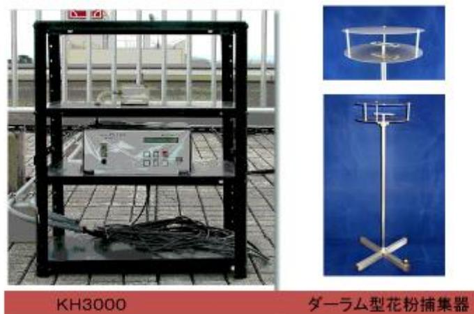
図3-8 花粉捕集器 左自動花粉捕集器、右ダーラム型花粉捕集器
