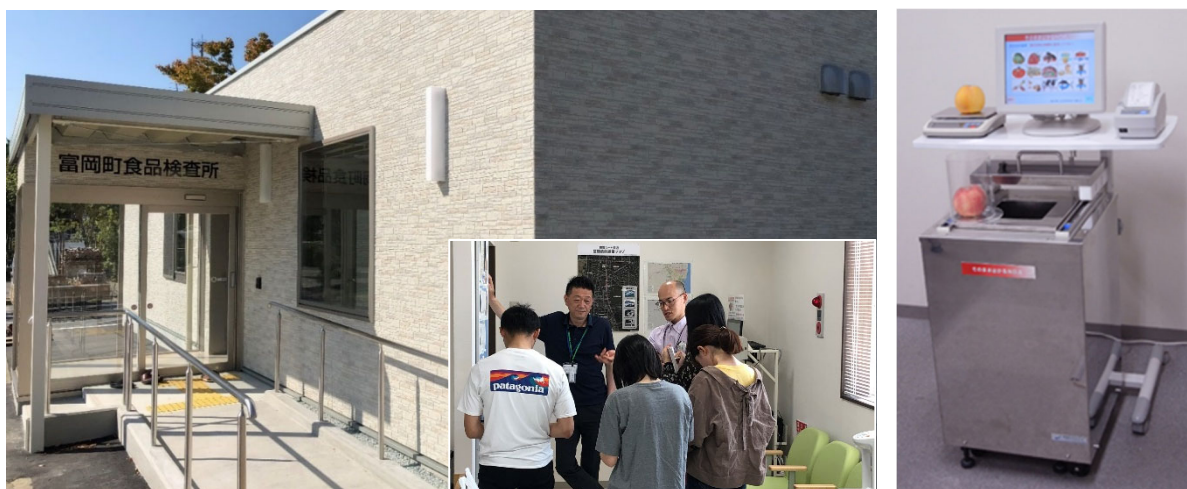
図 II-4 富岡町食品検査所（視察する学生）及びスクリーニング用の NaI スペクトロメータ
