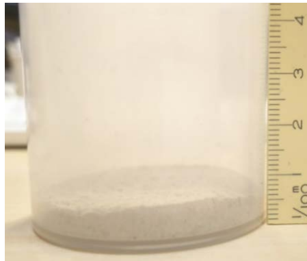
写真 7 U8 容器に回収した切削粉末(コンクリート試験体)
