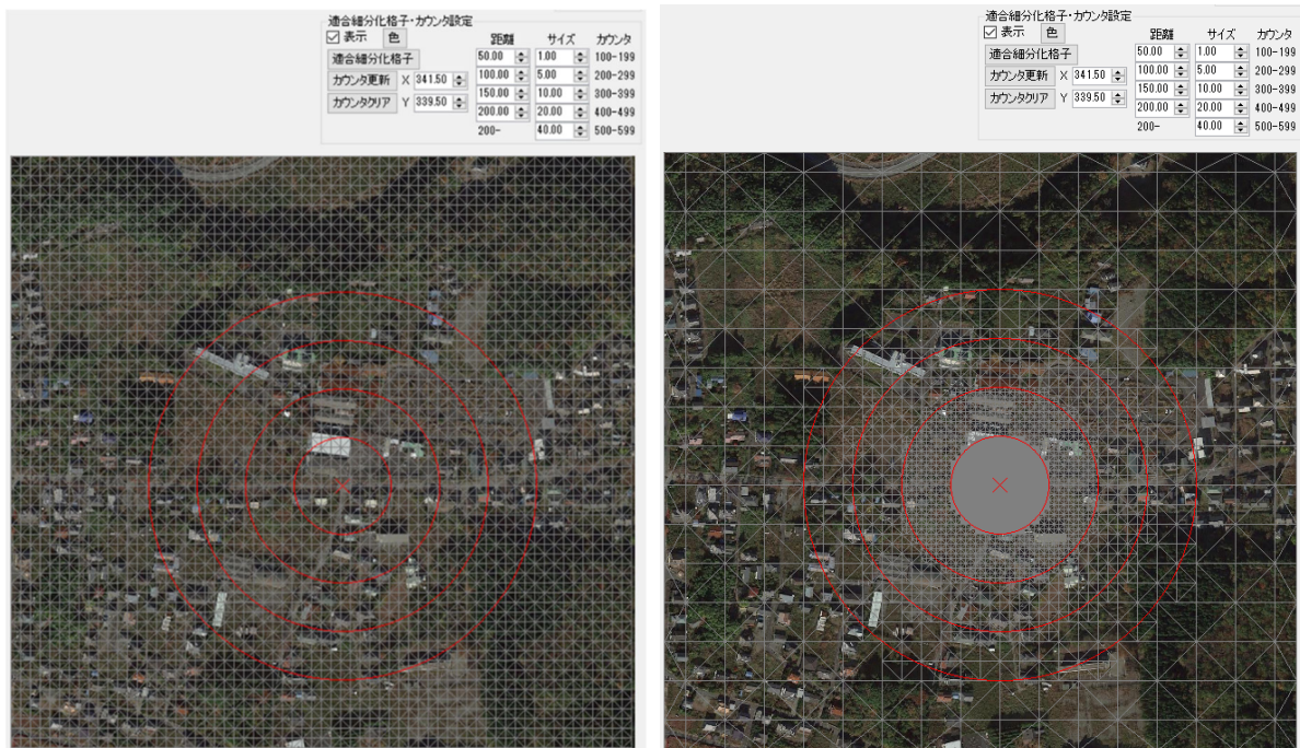
図 8 最適細分化格子の自動作成機能画像（左：格子作成前、右：格子作成後）
