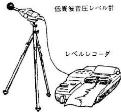
図-5.1.1 レベルレコーダによるG特性音圧レベルの測定系列の例
