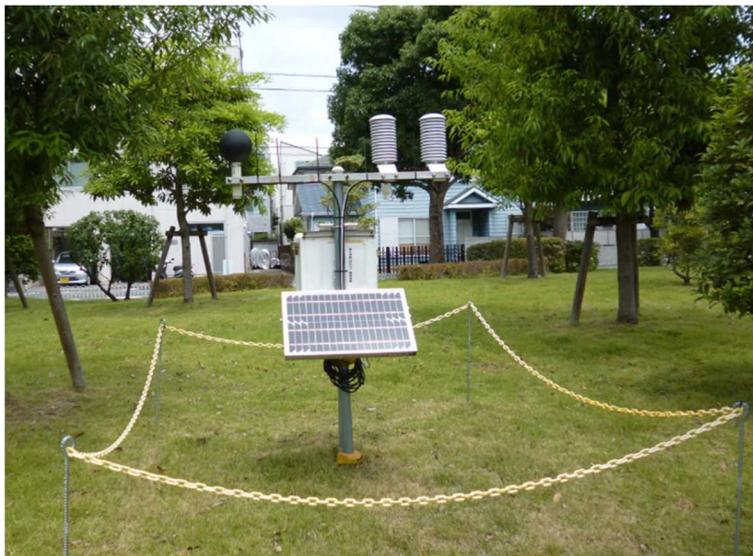
図 2-6(a) 標準型 単管パイプ利用設置例
