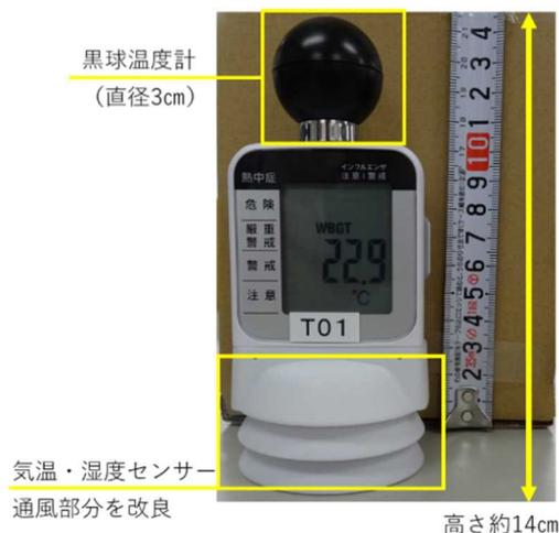
図 2-5 携帯型測定機器
