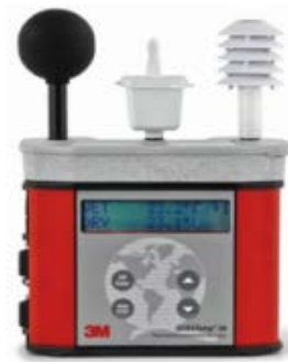
図 6-13 ISO 型測定機 （センサーは左から黒球温度、自然湿球温度、気温）
