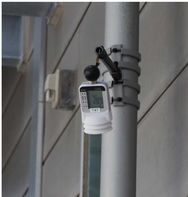
図 4-1 (d) 携帯型 建物付属管利用設置例
