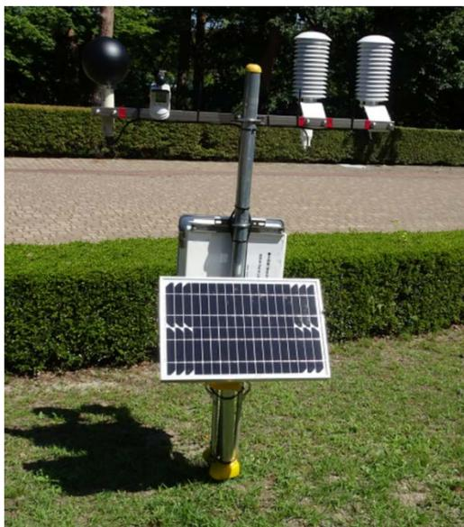
図 4-1(a) 標準型 単管パイプ利用設置例
